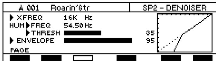
Xfreq parameter. Range: 63, 80, 100, 125, 160, 200, 250, 320, 400, 500, 635, 800, 1 k, 1.2k, 1.6k, 2k, 2.5k, 3.2k, 4k, 5k, 6.4k, 8k, 10k, 13k, 16k.
